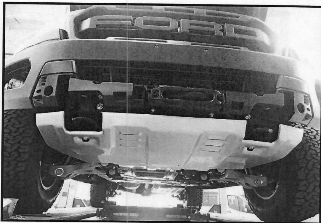
Mocowanie osłony dolnej. Attaching the bottom cover.
