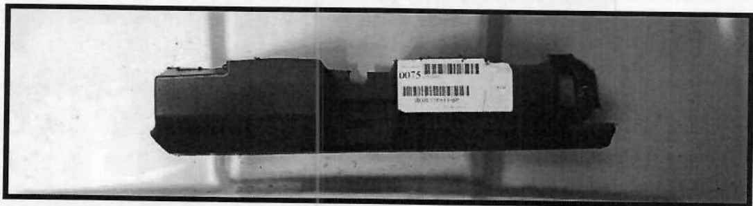
Cięcie niesymetryczne przedniej osłony. Asymmetrical cut of the front cover.
