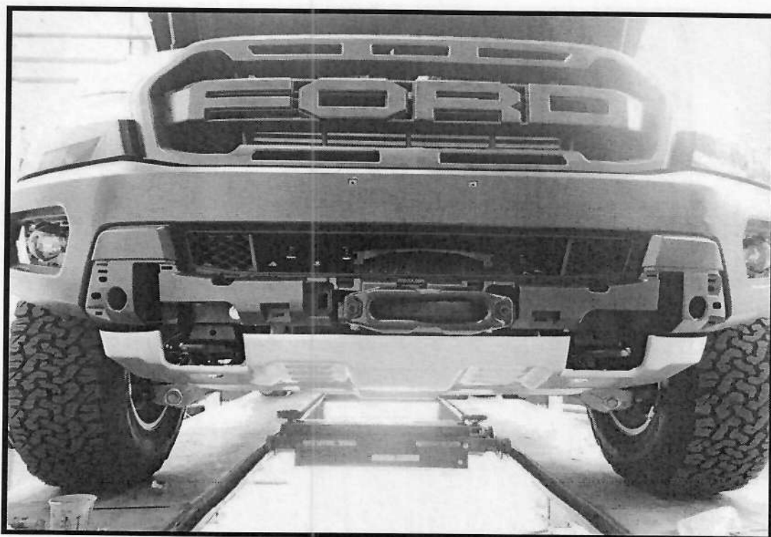
Mocowanie osłony dolnej. Attaching the bottom cover.
