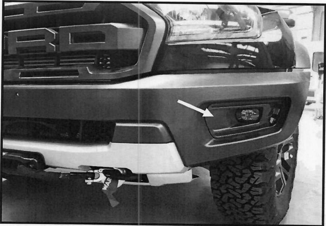
Nażożenie osłōn bocznych na lampy. Putting side covers on the lamps.
